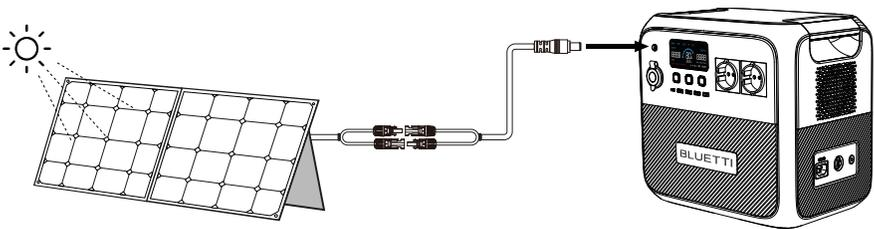
**Achtung!** Die Leerlaufspannung von Solarpaneelen darf 60V nicht überschreiten, da das Gerät andernfalls Schaden nimmt (Hinweis: fällt nicht unter die Garantie)
